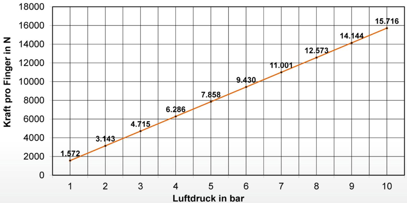
Con una presión del aire de 6 bar, la presión de contacto en las distintas regletas de bornes alcanza los siguientes valores:
