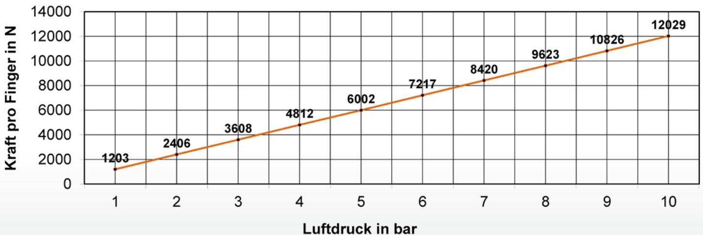
Con una presión del aire de 6 bar, la presión de contacto en las distintas regletas de bornes alcanza los siguientes valores:
